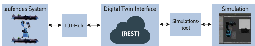
Die von iX vorgestellten Tools sitzen an den neuralgischen Punkten der digitalen Zwillinge. Ein Interface wird wie ein Hub immer benötigt, ein Simulationstool ist optional, aber häufig sinnvoll (Abb. 2).
